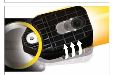
PHASE 3: Wenn die Energie ihr Maximum erreicht, wird die Kupplung weiter verdreht. Dabei rastet der Arretierungsstift im Pfosten ein und bewirkt eine Verdrehung des Pfostens, sodass verbleibende Kräfte abgebaut werden.
