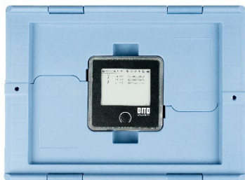
Der SmartHub kann als intelligentes Schloss in passive Kühlbehälter integriert werden. Er gewährt nur autorisiertem Personal Zugang.
