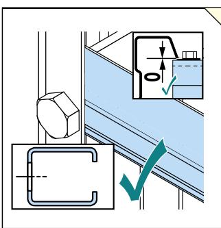
Bauteile spaltfrei montieren. (DE)
