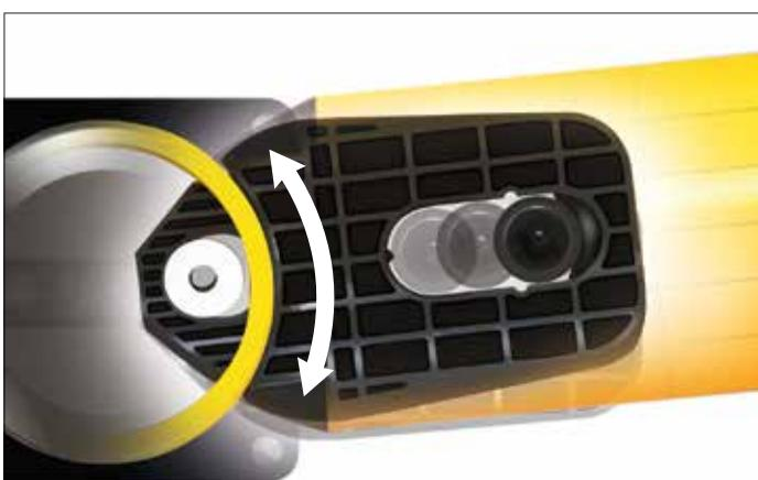
**PHASE 2:** Die Kompression in der Kammer erhöht sich und nimmt die Energie auf. Die Kupplung rotiert dabei um den Arretierungsstift im Pfosten und absorbiert weitere Energie.
