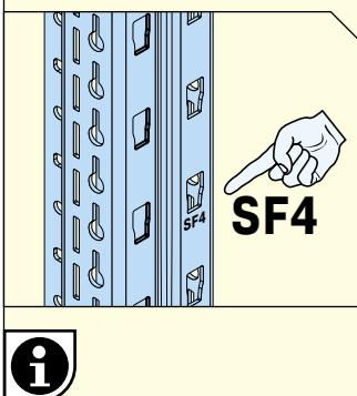
Bauteile spaltfrei montieren. (DE)
