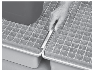
Einlegen der Abdeckschienen für einen festen Wannenverbund
