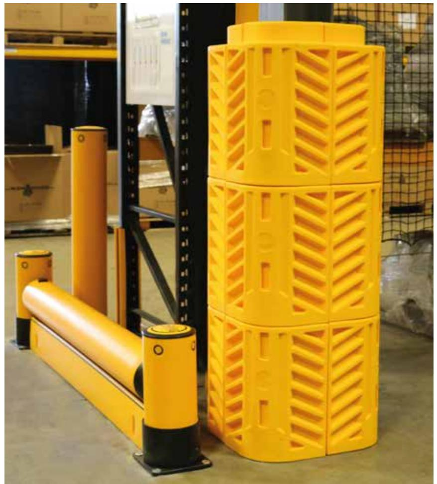
**Die Stufenstapelfunktion** verbindet mehrere Säulenschutzsysteme, sodass sie als integrierte Einheit fungieren. Die Stufenstruktur fixiert die gestapelten Module an Ort und Stelle und ermöglicht die Ableitung der Energie durch das gesamte System, was den Schutz in größeren Höhen weiter verbessert.
