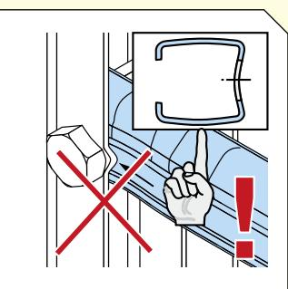
Bauteile spaltfrei montieren. DE
